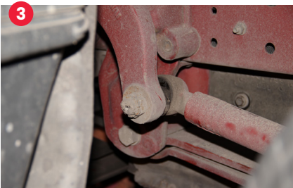
3- Tense el husillo hidráulico con la mano girando de la parte moleteada. / Tighten the hydraulic spindle manually turning the knurled part.
