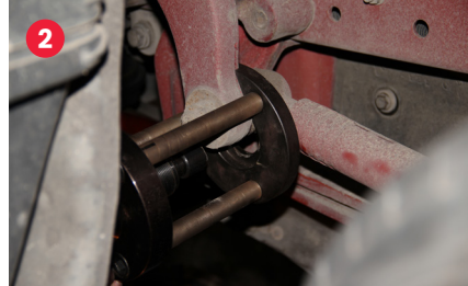
2- Colocar el extractor en la rótula según imagen. / Place the extractor on the ball joint according to the image.
